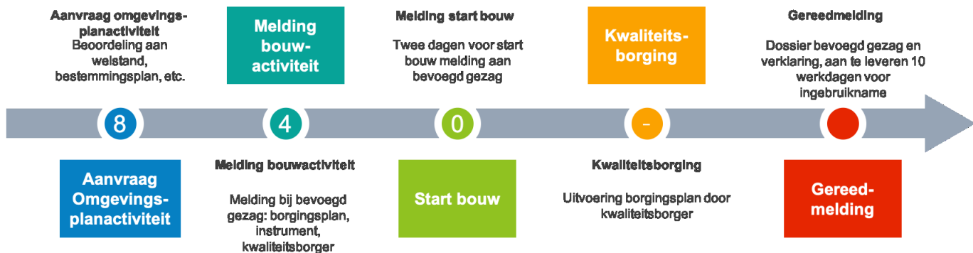
Figuur 1 Schematische weergave van het proces van bouwen onder de Wkb. De (aanvraag) omgevingsplanactiviteit is hier buiten beschouwing gelaten. Van links naar rechts ziet u de volgende stappen:
