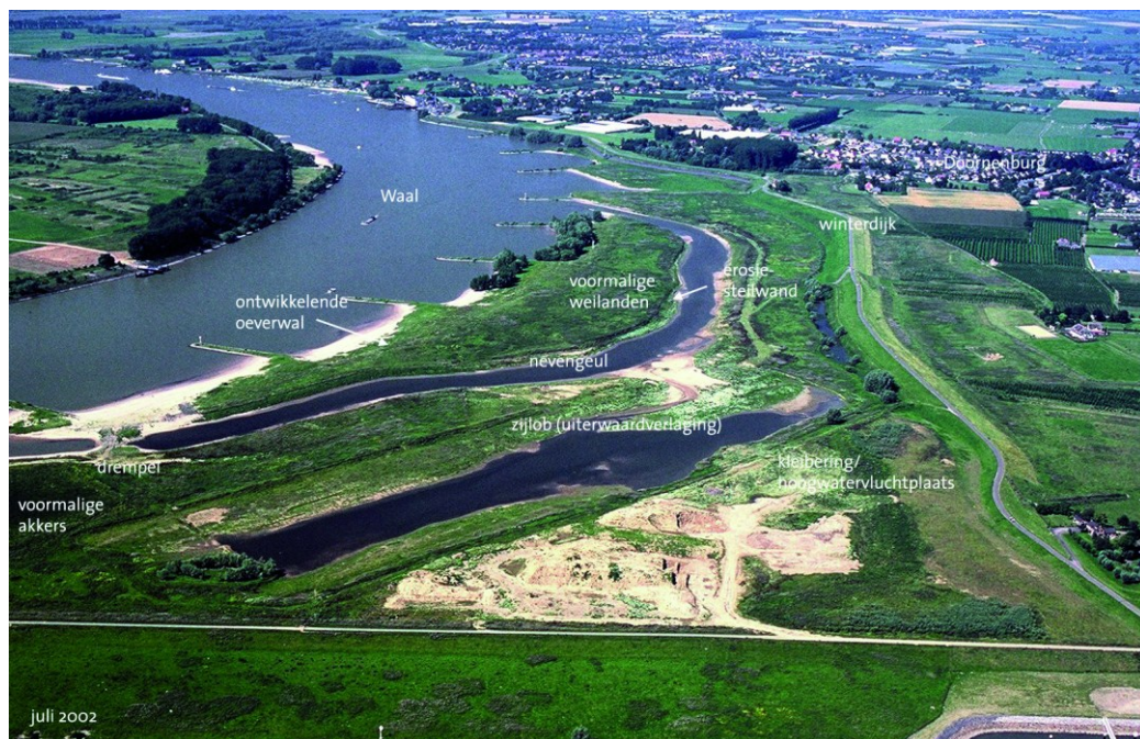
Figuur 1.16 Inrichting Klompenwaard. Er is goed gebruik gemaakt van de lokale waterstandsvariatie door veel hogere en diepere delen te creëren waardoor veel gradiënten zijn ontstaan (foto Fokko Erhart).
