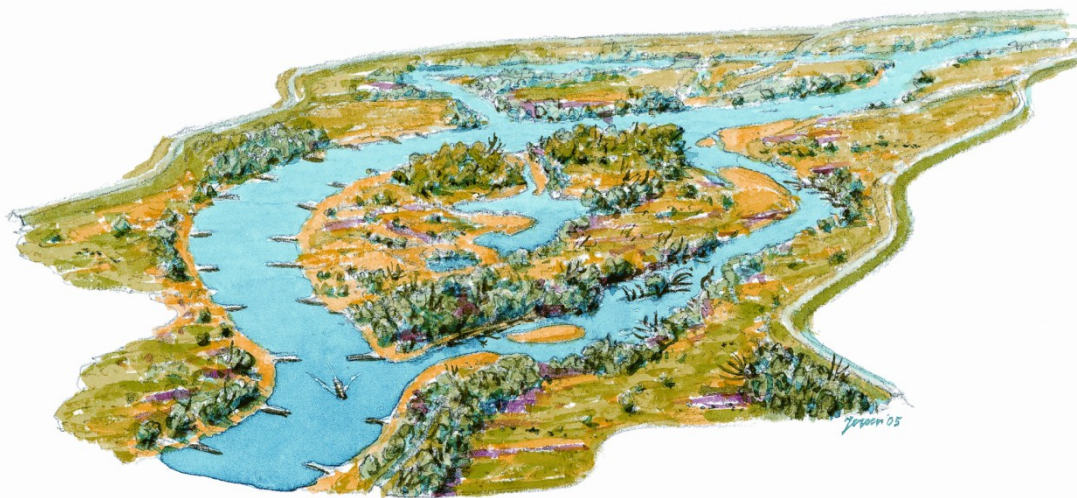
Figuur 1.1 Nevengeulen landschap langs een bekribde rivier. In tegenstelling tot de hoofdgeul, kunnen in nevengeulen allerlei erosie en sedimentatie patronen optreden die de lokale habitat diversiteit versterken. Zoals een in de nevengeul gevormde zandplaat, oevererosie en invallend hout door weggeërodeerde wilgen. (Bron: Handboek Cyclisch beheer, 2006.)
