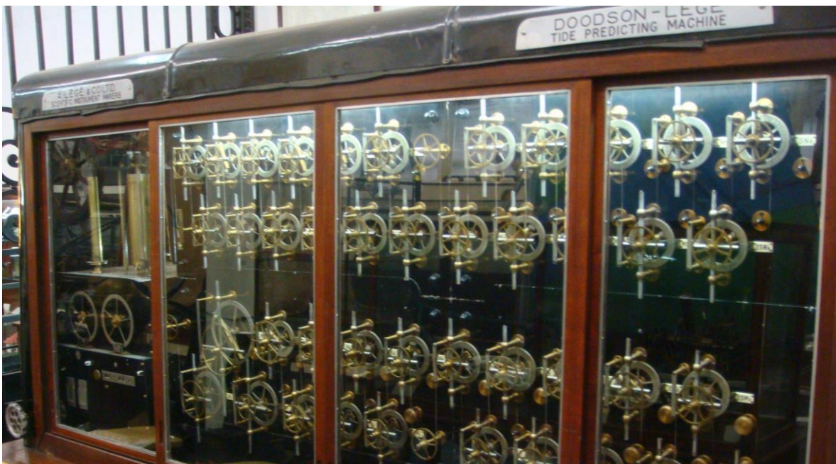
Met de Doodson Tide machine kon na analyse ook een predictie gemaakt worden
