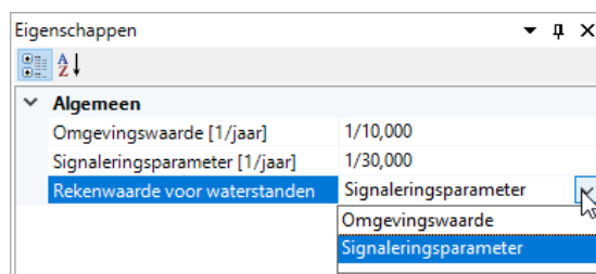
Figuur 11.19: Keuze voor de doelkans ten behoeve van de semi-probabilistische berekeningen faalmechanismen Piping (STPH) en Macrostabieliteit binnenwaarts (STBI)
