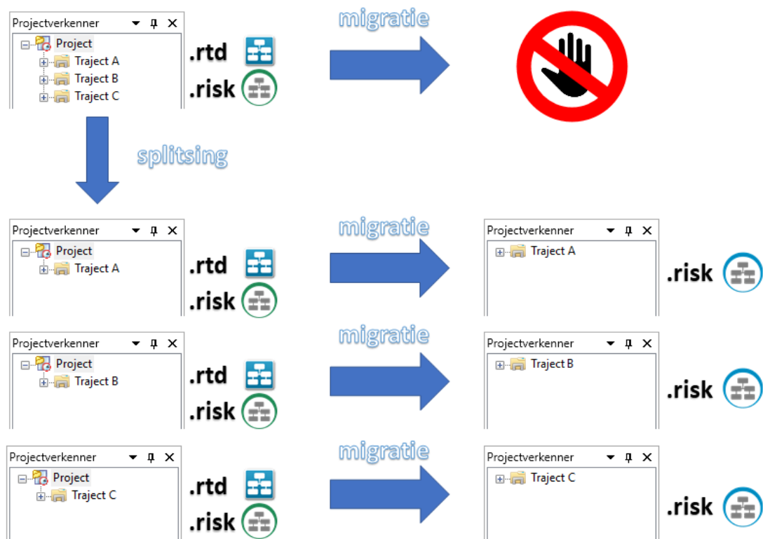
Figuur 9.1: Migratie van een project met meerdere trajecten dat gemaakt is in een versie ouder dan 22.1.1 (of Ringtoets) naar Riskeer 23.1.1
