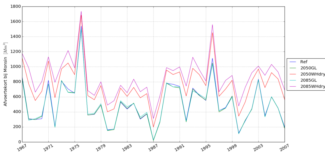
Figuur 3.8 Jaarlijkse afvoertekorten van de Maas bij Monsin (drempelwaarde van 150 \text{ m}^3/\text{s} ), huidige klimaat ('Ref') en klimaatscenario's G_L en W_{Hdry} in 2050 en 2085
