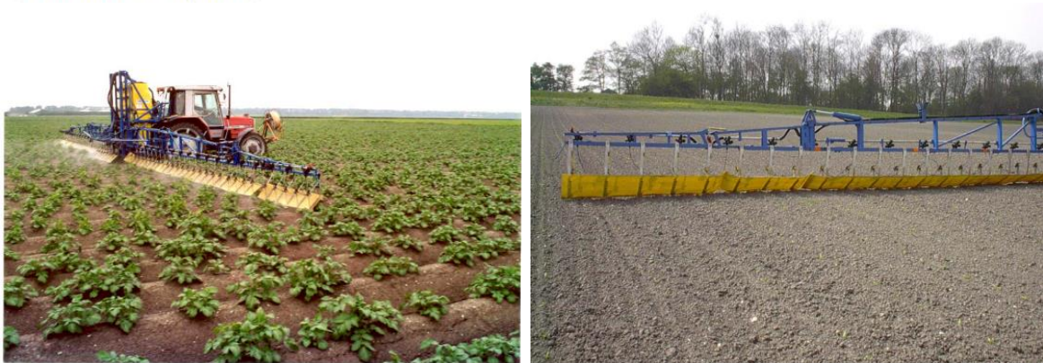
Figuur 3: Foto's veldspuit met Sleepdoeksysteem (bron: IMAG-WUR Nota P 2003-05, 'Gebruiksmogelijkheden van het Släpduk spuitsysteem in aardappelen, bieten en graan', januari 2003 (Van de Zande et al., (2003))).
